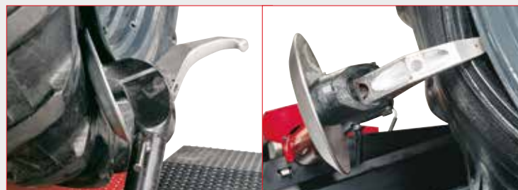
fase di stallonatura pneumatico tyre grooving phase
